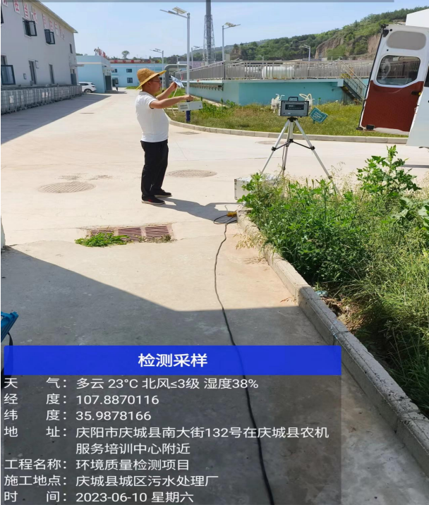
无组织废气:氨气、硫化氢、臭气浓度监控点 2#检测采样
